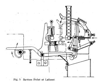
1. Spulenwechsler, bestehend aus einem senkrechten oder schrägen Spulenmagazin, entweder fest oder beweglich über dem Brustbaum angeordnet. Spulenhammer am Spulenmagazinsupport drehbar und durch die vorwärtsschwingende Weblade betätigt.
