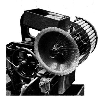
Fig. 8 Spulenwechsler der Georg Fischer Aktiengesellschaft, hervorgegangen aus der früheren Rauschenbach-Konstruktion Neues Modell 3000/01 mit Schützenwächter-Schere und schwingendem Fadenfänger
