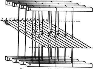
Einzug "geradedurch" in 4 Schäfte oder Flügel, Zählung von hinten nach vorn, des Arbeitsflußes Richtung.
