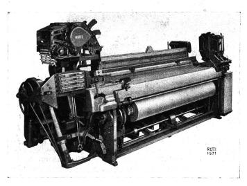
Métier automatique Ruti à 4 navettes pour cotonnades et lainages avec ratière Ruti et suspension latérale des lames, sans couronne (archivolte) 4 shuttle Ruti automatic loom for cotton and wool, with Ruti dobby and lateral suspension of the shafts, without superstructure
