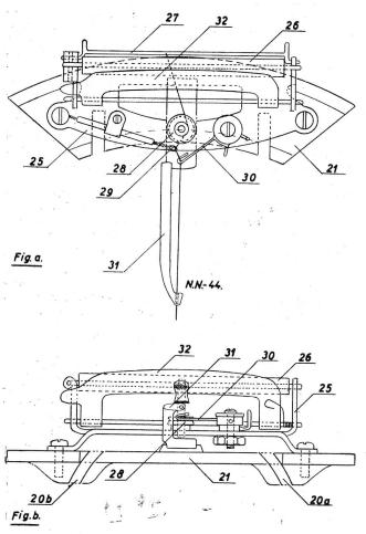
Fig. 6 Schiffchen vom Typ 36 B, a) Grundrifs, b) Aufsicht
