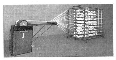
Spulengatter für Konusspulen u. zylindrische Kreuzspulen, bis 1,5 kg
