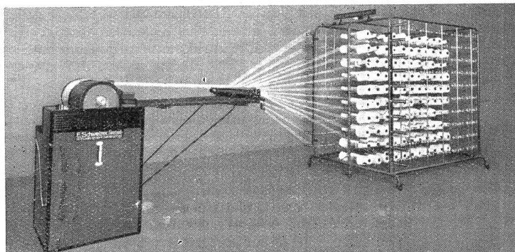
Spulengatter für Konusspulen u. zylindrische Kreuzspulen, bis 1,5 kg
