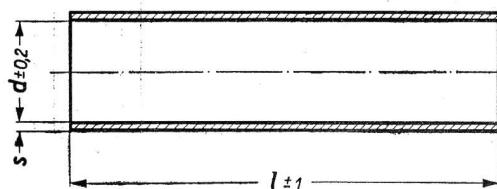
Bezeichnung einer zylindrischen Kreuzspulhülse Form B von Länge  $l = 145$  mm, Innendurchmesser  $d = 16$  mm und Wanddicke  $s = 2,5$  mm
