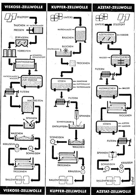
Abb. 4. Schematische Darstellung der Zellwolle-Erzeugung
