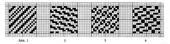
Bei näherem Vergleich der neuen Bindungen zeigt sich nun, daß dieselben in der Kettrichtung stets die gleiche Anzahl Fadenverkreuzungen aufweisen wie die Originalbindung, nicht aber in der Schußrichtung. Der Griff der Ware wird bei den Bindungen 2 und 4 wesentlich weicher ausfallen als bei der Originalbindung. Grund: weniger Fadenverkreuzun-
