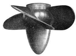
Laufrad einer von 2 Propellerturbinen, mit verstellbaren Leitradschaufeln, für 192 PS Leistung und 2 m 10 Gefälle
