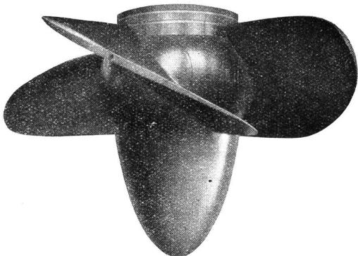
Laufrad einer von 2 Propellerturbinen,
