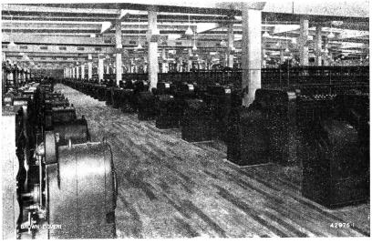
Abb. 4. — Baumwoll-Ringspinnmaschinen mit regulierbarem Antrieb durch Dreiphasen-Nebenschluß-Kommutatormotoren mit Spinnregler.
