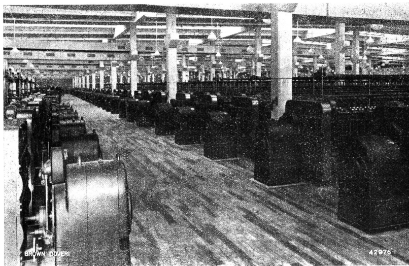
Abb. 4. — Baumwoll-Ringspinnmaschinen mit regulierbarem Antrieb durch Dreiphasen-Nebenschluß-Kommutatormotoren mit Spinnregler.
