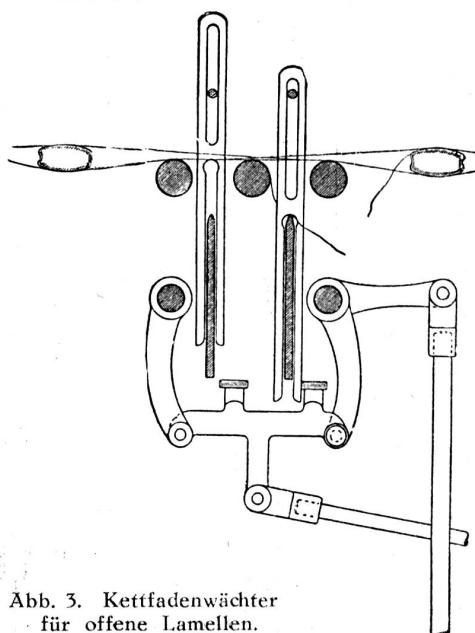
Abb. 3. Kettfadenwächter für offene Lamellen.
