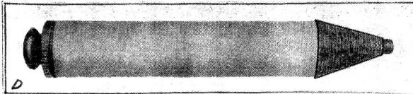
auch andere unbenötigte Spulen von den Brettstiften; diese fallen in den Webstuhl, werden gebrochen, auch auf den ölfleckigen, bestaubten Boden unter dem Webstuhl beschmutzt. Vor dem Spuleneinsetzen werden die Hütchen abgenommen und ineinander auf einen leeren Spulbrettstift aufgesteckt und gelangen mit dem leeren Brett zu erneutem Gebrauche in die Spulerei zurück.
