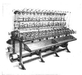
Kreuzschuß-Spulmaschine "Seta-Rapid", Typ SR
