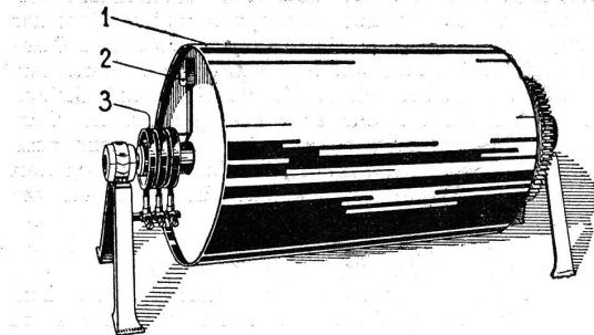
In der obenstehenden Abbildung ist eine Trommel mit elektrischer Heizung ausgerüstet ersichtlich. 1 ist der von beheizte Cylinder, 2 der Temperaturregulator, 3 die Schleifringe für den Heizstrom.
