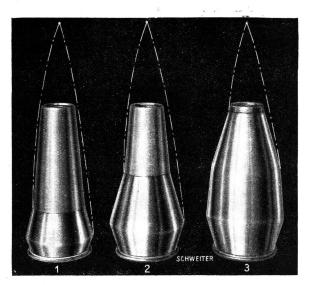
Wenn dieser so gebildete Anfangskegel (Fig. 2) der Spule einen größten Durchmesser gleich dem gewünschten fertigen Durchmesser der Spule erreicht hat, erfolgt die Weiterbildung der Spule gemäß Fig. 3 je nach Material und Verwendungszweck.
