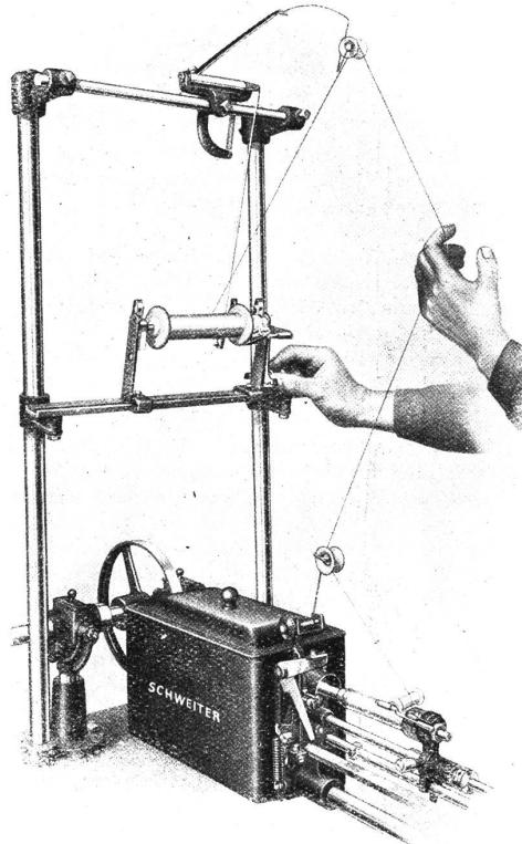
der abrollenden Spule hinsichtlich Feinheit und Stärke des Materials genau angepaßt und eine durchaus gleichmäßige Umdrehungszahl der Spule erzielt werden. Die Bildung von Glanzschüssen oder die Gefahr einer Verstreckung des Materials bei Kunstseide z. B. sind somit gänzlich vermieden.
