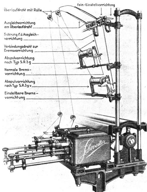
Die Abspulvorrichtung und die Lagerung der Abrollspindeln ist äußerst einfach und sinnreich. Durch eine leichte Handbewegung kann die Spindel ohne jegliches Suchen eingesetzt oder herausgenommen werden. Eine weitere Neuerung hat ferner die Bremsung der Abrollspule erfahren, indem durch eine besondere Konstruktion mit Gurtenspannung eine elastische und weiche Bremsung erreicht wird. Leicht einstellbar, sogar während des Laufens, kann die Bremsung
