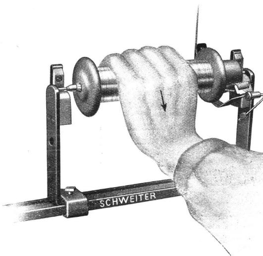
Durch Lagerung der Frikitions- und Antriebswellen in Kugellager, ist ferner der Kraftbedarf der Maschine herabgesetzt worden.
