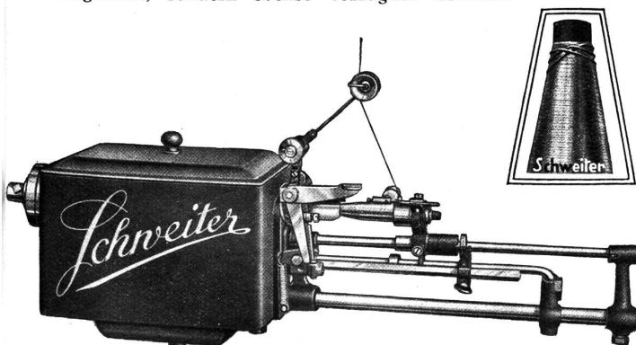
Die Bauart der Maschine beruht auf dem bewährten Einzelspindelprinzip, d.h. jede Spindel ist wagrecht gelagert und hat in einem besonderen Kasten mit Oelbad ihren eige-
