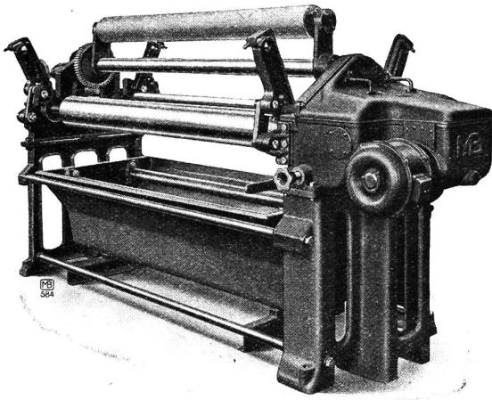
in der Breitfärberei eingeführt wurden und mit bestem Erfolg Eingang gefunden haben. Sie sind geeignet, den bisher angewandten, primitiven Handjigger mit der Zeit zu verdrängen. Diese moderne, leistungsfähige Maschine ist inzwischen weiter ausgebaut und derart verbessert worden, daß sie nunmehr auch zum Färben sehr empfindlicher Gewebe Verwendung finden kann.
