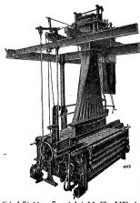
6-schütziger Spezialstuhl für Möbel-und Korsettstoffe, Modell DWSC, kom-biniert mit RÜTI-Jacquardmaschine
