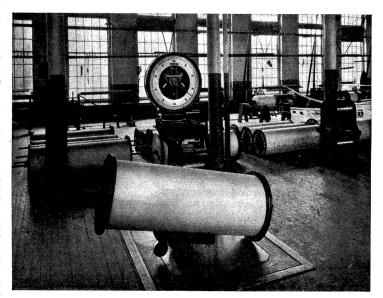
Toledo-Waage in der Zettlerei.
