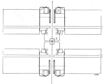
Abb. 10. Anordnung der Leitungsverlegung für Webstuhl-Einzelantriebe. 1 = Motor. 2 = Schalter. 3 = Verteilungskasten.
