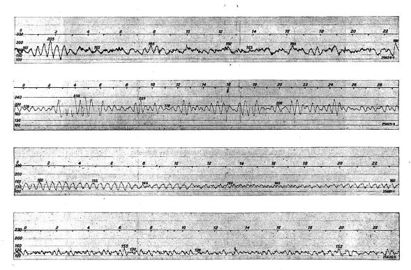
Abb. 1. Tachogramme von Webstühlen mit Transmissionsantrieb.
