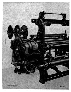
Abb. 5. Baumwollautomat mit Brown Boveri-Rüti-Zahnradantrieb.
