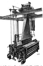
6-schütziger Spezialstuhl für Möbel-und Korsettstoffe, Modell DWSC, kom-biniert mit RÜTI-Jacquardmaschine
