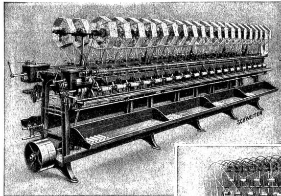
Pat. Spindellose Windmaschine
