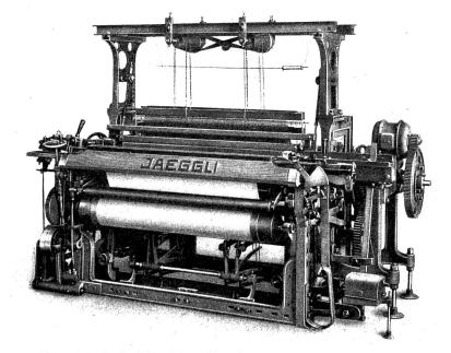
Hochleistungs-Schnelläufer-Seiden-Crêpestuhl "Universal" 126 cm, mit elektrischem Zahnrad-Einzelantrieb
