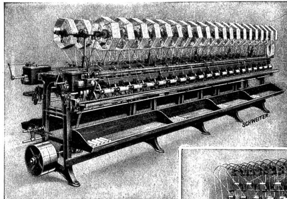
Pat. Spindellose Windemaschine
