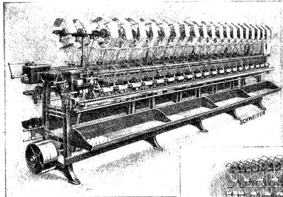
Pat. Spindellose Windmaschine
