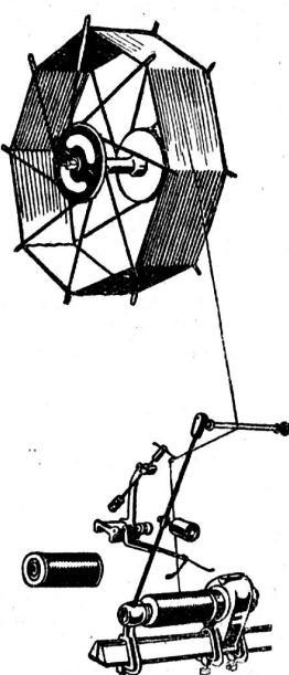
Die patent. spindellose Windmaschine erübriggt das Umspulen, da der Faden durch eine Balance ausgeglichen und gleichmäßig gespannt aufgewickelt wird. Durch eine sinnreiche Aufspulvorrichtung wird der Faden zart vom Haspel abgezogen
