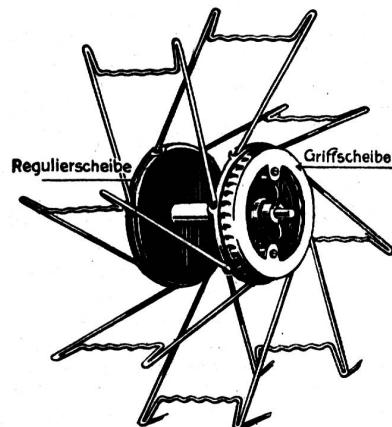
Das genaue Rundlaufen, die geringe Schwungkraft, das weiche, technisch einzig richtige und schnelle Auflegen der Strangen, sowie seine unverwüstliche Bauart haben den Haspel „PERFECT“ an erste Stelle gebracht. Erfinder und Konstrukteur des patent. verstellbaren Häsps „PERFECT“ ist die Firma Brügger & Co., Textilmaschinenfabrik, Horgen (Schweiz).
