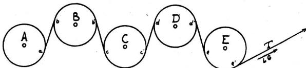
beider gehen unter C durch, vereinigen sich mit C usw. In E vereinigen sich die Fäden von A, B, C und D mit denen von E, um die in die Schlichtmaschine einlaufende endgültige Kette zu bilden.
