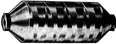
Die Herstellung dieser Spulen erfolgt auf Spulapparaten, resp. Maschinen, welche Vorrichtungen besitzen, zur automatischen Verkürzung der Wickellänge bzw. des Hubes bei zunehmendem Durchmesser der zu wickelnden Spule, wobei der Hubverkürzungs-Apparat entweder direkt vom zunehmenden Durchmesser der Spule, also von ihrer Oberfläche aus, betätigt wird oder aber unabhängig von der Spule durch Schaltwerke, welche von der Spulspindel oder dem Fadenführer bewegt werden.
