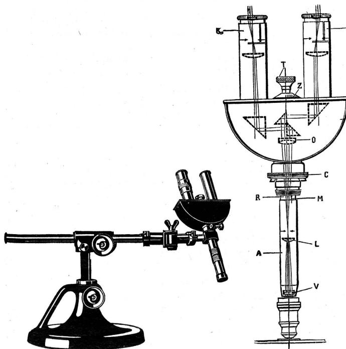
men in zwei Hälften geteilt und jede Hälfte durch je ein seitlich gelegenes Prisma in die Okulare geleitet. Das Stereomikroskop besitzt größere Lichtstärke, größere Tiefenwirkung und dadurch
