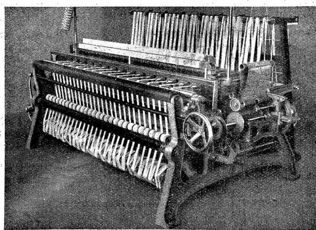
Schafftbewegung. Diese Maschine arbeitet bei einer minutlichen Tourenzahl von 200 noch absolut sicher. Als letzte Neuerung ist die Ausstattung des Stuhles mit einem positiv arbeitenden Regulator zu erwähnen, der, ohne ein Wechselrad auszutauschen oder Verstellen einer Schaltschiene, durch Einstellen zweier Hebel in weiten Grenzen reguliert werden kann.
