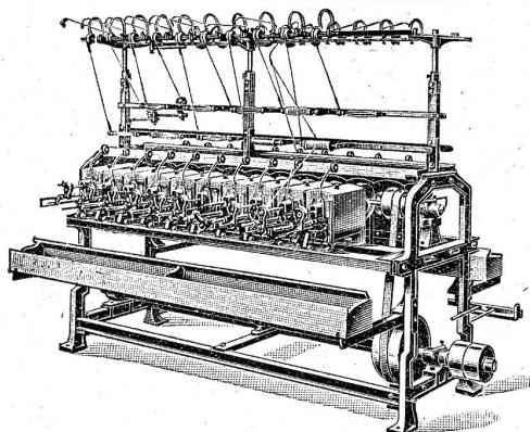
Pat. Kreuzschußspulmaschine, Produktiv CK
