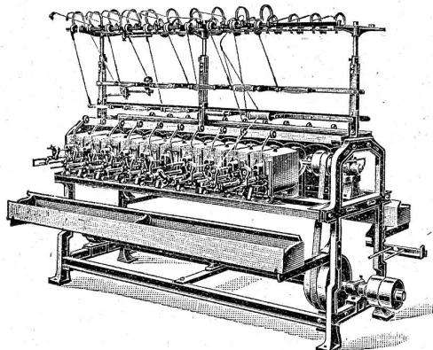
Pat. Kreuzschußspulmaschine, Produktiv CK
