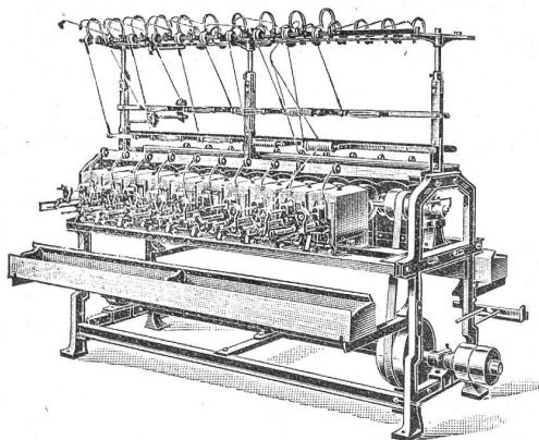
Pat. Kreuzschußspulmaschine, Produktiv CK
