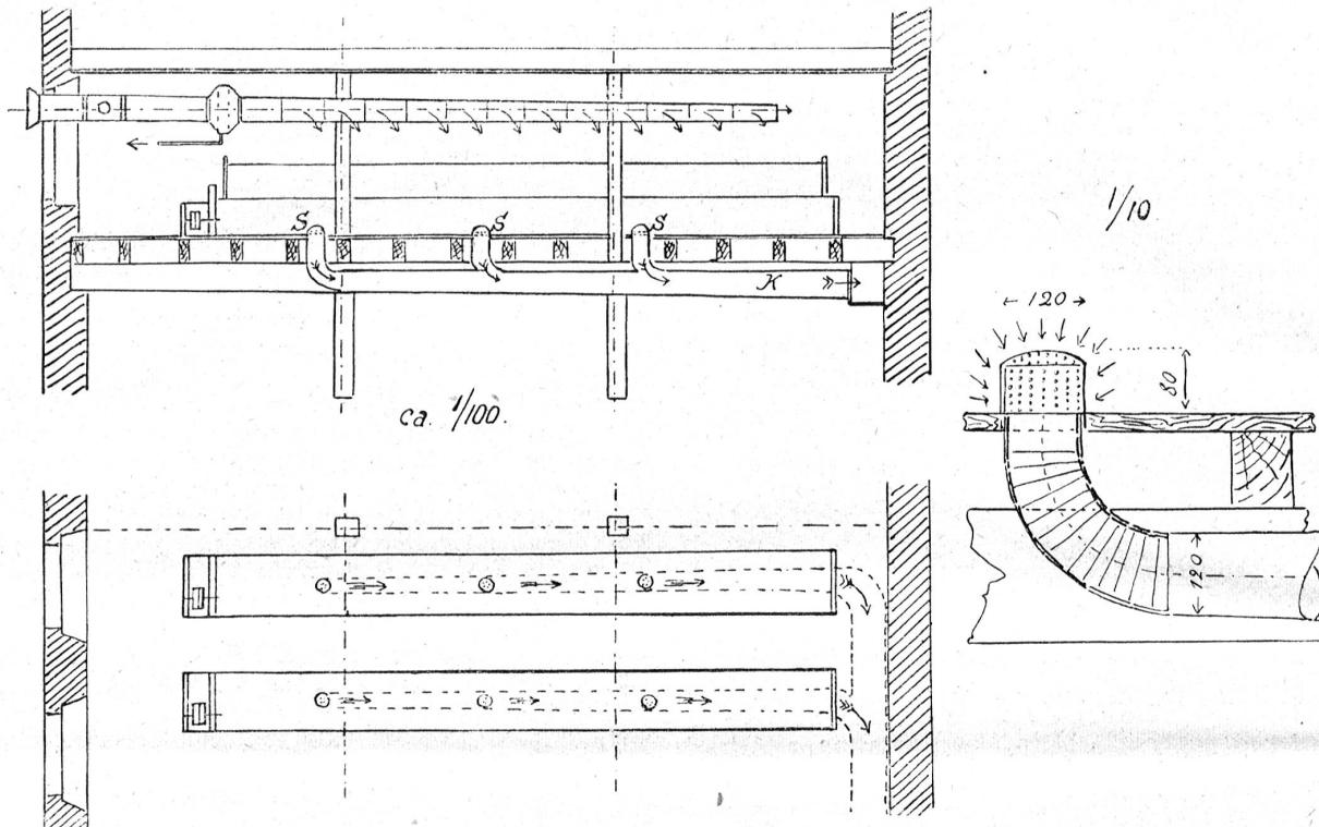
Die Abluft entweicht durch Siebhauben s, um das Mitreißen von Abfällen zu verhindern, gelangt in unter der Decke befindliche entsprechend weite Kanäle und wird durch einen am gemeinschaftlichen Abzugskanal angebrachten Ventilator abgesaugt. Befeuchtungsanlagen, die nur feuchte Luft in das betreffende Lokal hineinblasen, ohne die verbrauchte Saalluft abzuführen, haben einen schlechten Wirkungsgrad.
