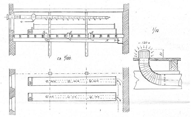
Die Abluft entweicht durch Siebhauben s, um das Mitreißen von Abfällen zu verhindern, gelangt in unter der Decke befindliche entsprechend weite Kanäle und wird durch einen am gemeinschaftlichen Abzugskanal angebrachten Ventilator abgesaugt. Befeuchtungsanlagen, die nur feuchte Luft in das betreffende Lokal hineinblasen, ohne die verbrauchte Saalluft abzuführen, haben einen schlechten Wirkungsgrad.
