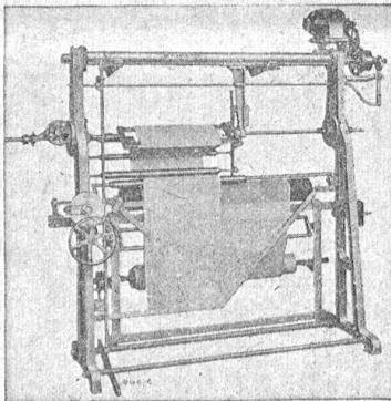
Wird auf Wunsch so eingerichtet, daß Seidenpapier zwischen die Falten eingewickelt werden kann.
