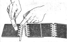
elastischer Gelenk-Riemen-Verbinder aus Stahl Einfachster,
