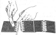
"Combinator elastischer Gelenk-Riemen-Verbinder aus Stahl Einfachster, bester Verbinder Für die Befestigung bedarf es nur des Hammers
