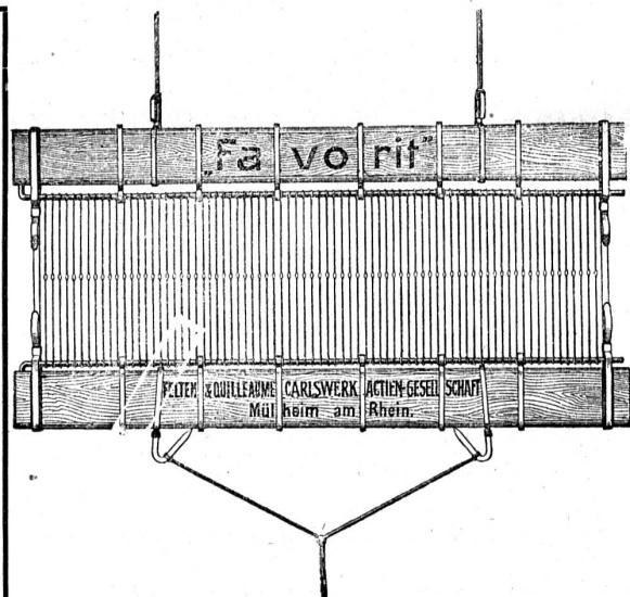
**Gusstahldraht - Webelitzen** auf patentierten
