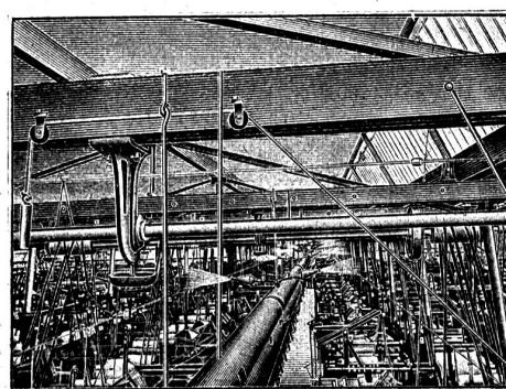
Aus ökonomischer Rücksicht ist es daher unerlässlich, den Feuchtigkeitsgehalt der Luft in Textilwerkstätten, namentlich in der kalten Saison, zu erhöhen, um das Aufspeichern der Elektrizität in den Fasern und auf den Maschinen hintanzuhalten, d. h. künstliche Befeuchtung anzuwenden.
