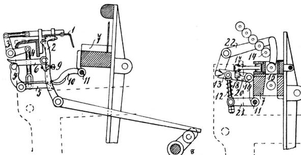
der Faden oder läuft die Spule zu Ende, so hört der Zug im Faden auf und die Nadel  $d$  nimmt die Lage  $d^2$  an, d. h. sie schnellte empor und tritt mit einer Ausrückvorrichtung in Verbindung.
