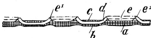
Das Gewebe *a* besteht aus den beiden Lagen *b*, *c*, zwischen welche Gummifaden *d* von beliebigem Querschnitt eingelegt und in geeigneter Weise derart abgebunden sind, daß die Faden an der Außenseite des Gewebes bei *e* austreten und alsdann flott liegen. Diese außenliegenden Fadenpartien *e* werden dann bei *e*<sup>1</sup> abgeschnitten, und zwar vorteilhaft wird
