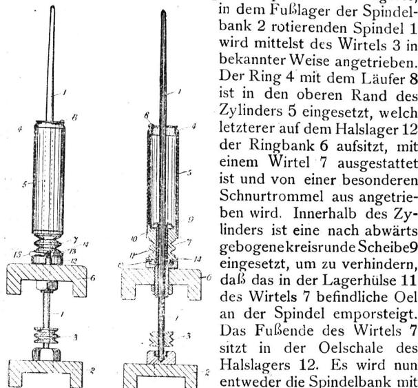
und die Ringbank mit Zylinder und Ring feststehend angeordnet, oder es werden Ringbank, Zylinder und Ring auf und ab geführt, und die Spindelbank mit der Spindel bleiben in fester Stellung. Spindel und Zylinder können sowohl in gleicher als in entgegengesetzter Richtung zu einander und in gleicher wie in abweichender Geschwindigkeit angetrieben werden, je nach der erforderlichen Fadenspannung, die durch gleiche Rotationsrichtung von Spindel und Ring auf ein Minimum reduziert werden kann.
