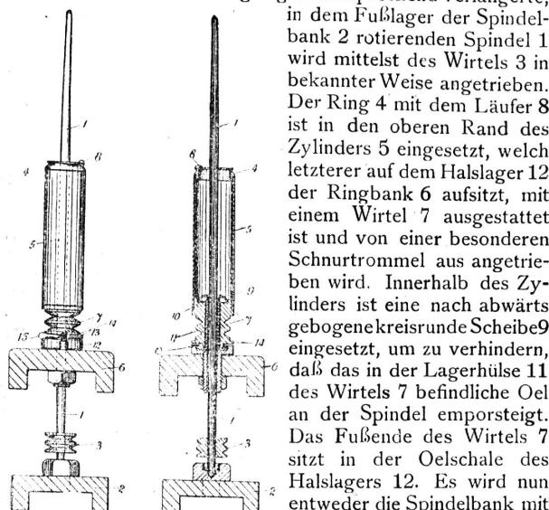
und die Ringbank mit Zylinder und Ring feststehend angeordnet, oder es werden Ringbank, Zylinder und Ring auf und ab geführt, und die Spindelbank mit der Spindel bleiben in fester Stellung. Spindel und Zylinder können sowohl in gleicher als in entgegengesetzter Richtung zu einander und in gleicher wie in abweichender Geschwindigkeit angetrieben werden, je nach der erforderlichen Fadenspannung, die durch gleiche Rotationsrichtung von Spindel und Ring auf ein Minimum reduziert werden kann.
