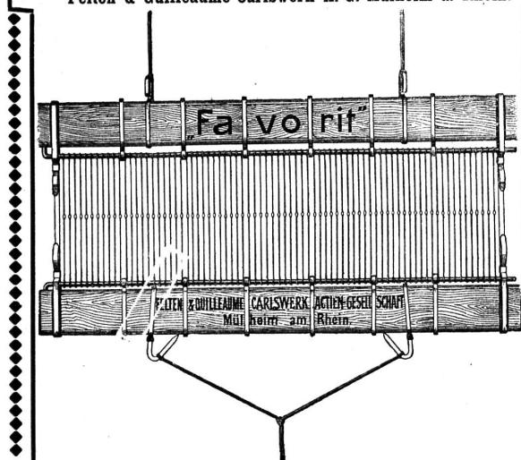
**Gusstahldraht - Webelitzen** auf patentierten
