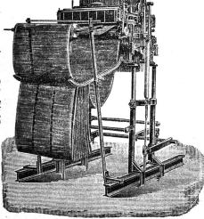
Doppelhub- und Zweizylinder-Jacquardmaschine Hochfach- Hoch- und Tieffach-Maschine
