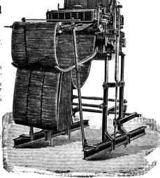
Doppelhub- und Zweizylinder-Jacquardmaschine Hochfach- Hoch- und Tieffach-Maschine mit separaten Bordurendessin für Foulardfabrikation sehr geeignet
