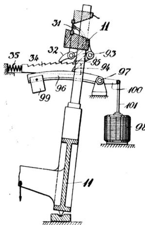
Der andere Arm 100 des Führungsstückes ist durch eine Stange 101 mit dem Kern eines Solenoides 98 verbunden, das dauernd von Strom durchflossen wird, somit seinen Kern eingezogen und damit die Leitbahn 96 in bestimmter Lage erhält. Die zweite Klinke 95 auf der Welle 93 streicht bei der Bewegung der Lade über einem Sperrstück 34 hin, aber nur dann, wenn bei erregtem Solenoid 98 die Leitbahn 96 in angehobener Lage erhalten ist.
