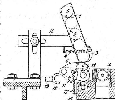
Seite gedrängt wird und gleichzeitig mit zur Führung der Spule dient. Schwingt darauf die Lade zurück, so klappen die Teile 6 und 9 zusammen, indem der Teil 6 durch die Schraubenfeder 17 gegen den Teil 9 gezogen wird. Die in dem Spulenbehälter liegenden Spulen rutschen nach unten und werden von neuem durch die in ihre Anfangslage zurückgekehrte Klappe 3 getragen. Während des Einlegens der Spule wird der Spulenbehälter nach unten durch den Teil 6 geschlossen gehalten.
