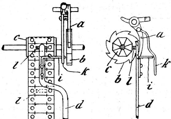
ein bewegliches Ablenkungsorgan geschoben, welches, wenn der Grund gewebt werden soll, einerseits durch einen Kartenanschlag, anderseits durch eine im Maß der fortgeschrittenen
